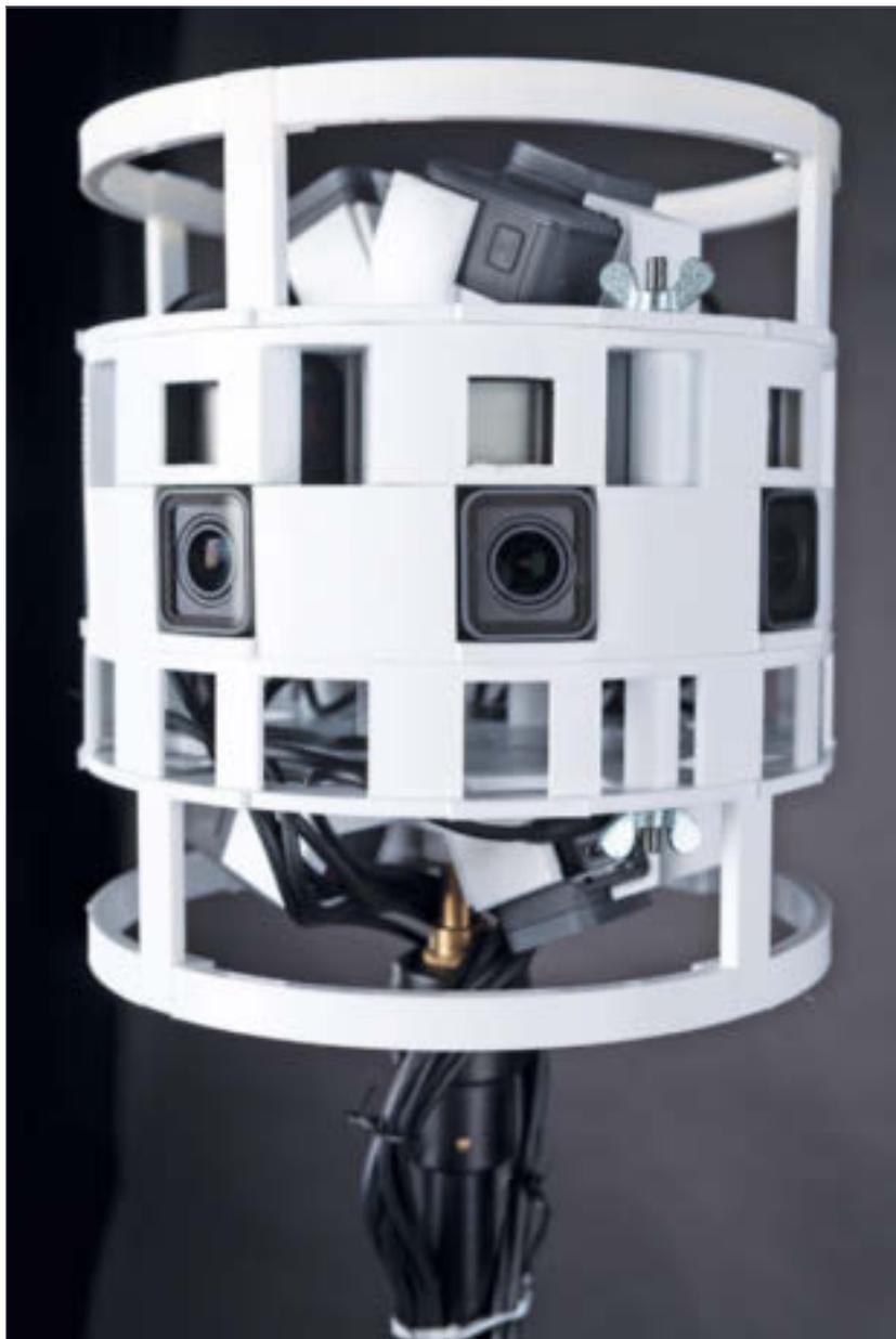
Ziel der Designs ist es, mehrere Kameras in einer bestimmten Ausrichtung und Anordnung zu fixieren, um das gewünschte Ergebnis zu erzielen, in unserem Fall die Erzeugung eines zylindrischen oder sphärischen 360-Grad-Videos.
