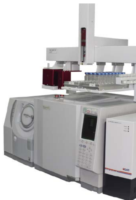
Abb. 1: Für die Analyse eingesetztes HS-GCxIMS/GC-MS-System, basierend auf einem Gaschromatographen mit zwei separaten Flusslinien, einem statischen Headspace-Autosampler, einem Quadrupol-Massenspektrometer (links) und einem Driftrohr-Ionenmobilitätsspektrometer (rechts).
